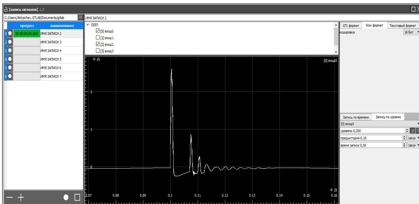
Воспроизведение сигналов с возможностью выделения отдельных фрагментов для их последующего спектрального анализа
